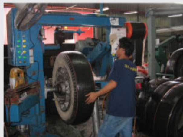
Tayar celup akan dimasukkan ke dalam satu mesin khas bagi melengkapkan proses pembuatannya.
